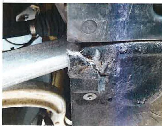
Beschädigung 1: Karosserie: Unterbodenverkleidung - gebrochen / gerissen - erneuern
