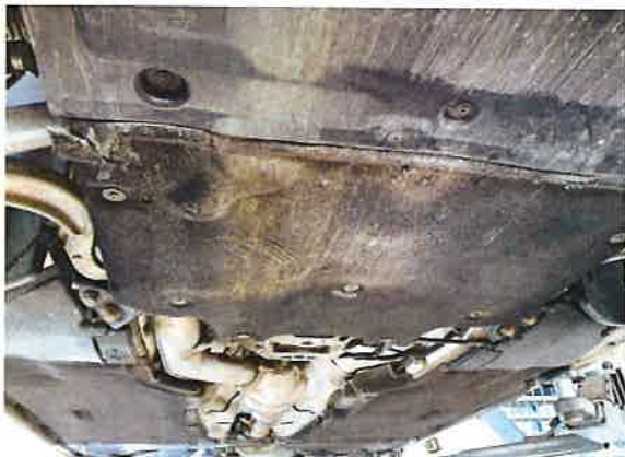
Beschädigung 1: Karosserie: Unterbodenverkleidung - gebrochen / gerissen - erneuern
