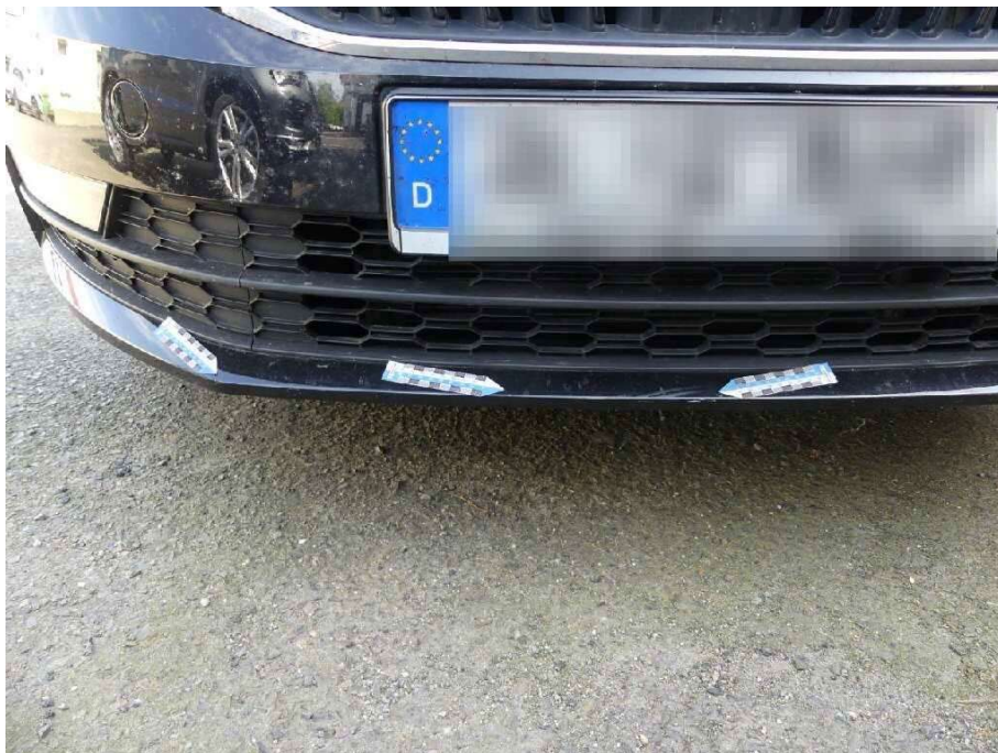
Bild 45 Fahrzeugfront Stoßfänger vorne verkratzt
