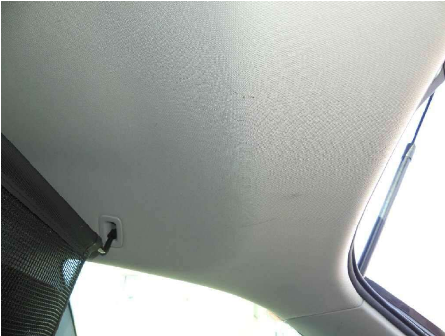
Bild 21 Innenraum Dachhimmel hinten beschädigt
