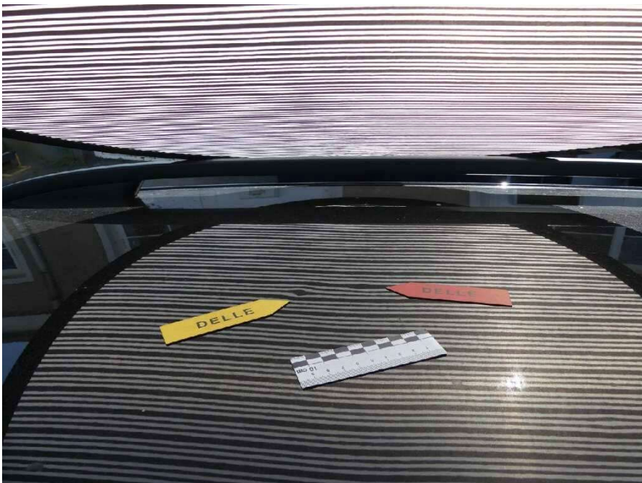
Bild 40 Dach Dach 3 Dellen
