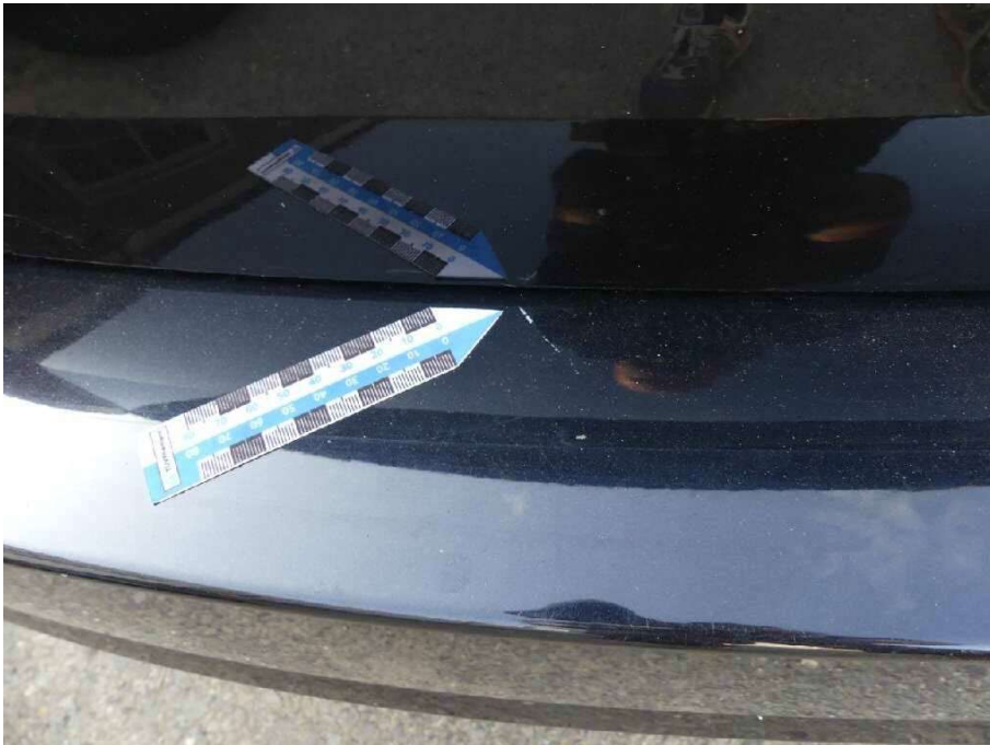
Bild 51 Fahrzeugheck Stoßfänger hinten verkratzt
