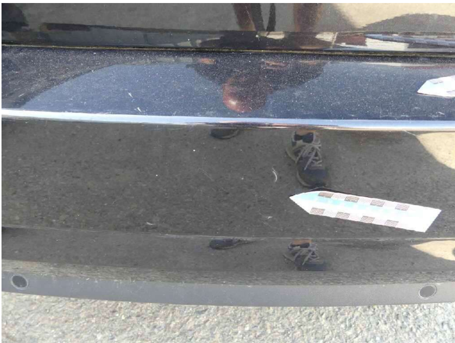
Bild 50 Fahrzeugheck Stoßfänger hinten verkratzt
