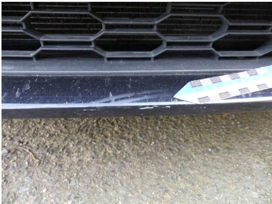
Bild 46 Fahrzeugfront Stoßfänger vorne verkratzt
