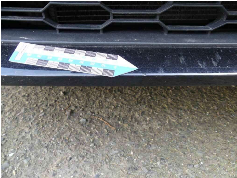
Bild 47 Fahrzeugfront Stoßfänger vorne verkratzt
