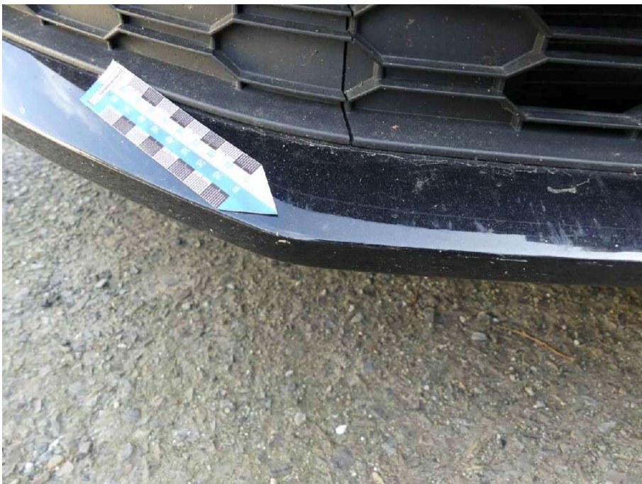
Bild 48 Fahrzeugfront Stoßfänger vorne verkratzt
