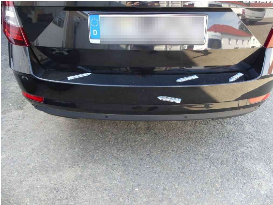
Bild 49 Fahrzeugheck Stoßfänger hinten verkratzt
