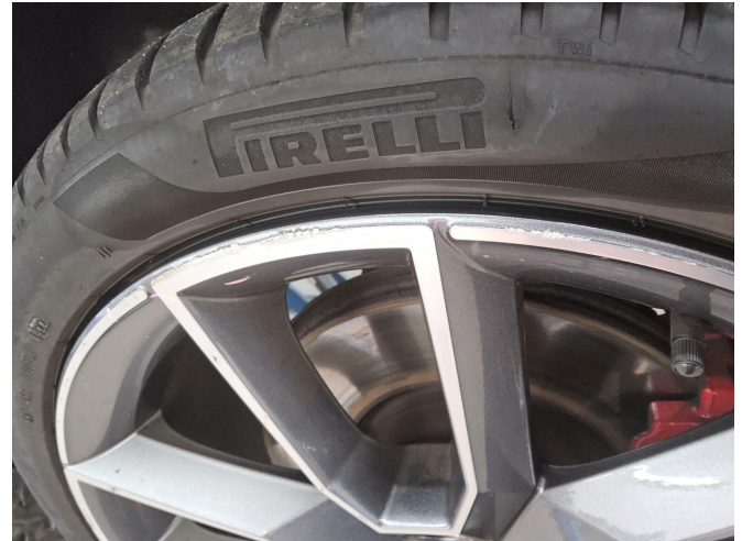
Bild 2: Außen, 2 Leichtmetallfelgen , beschädigt , instandsetzen
