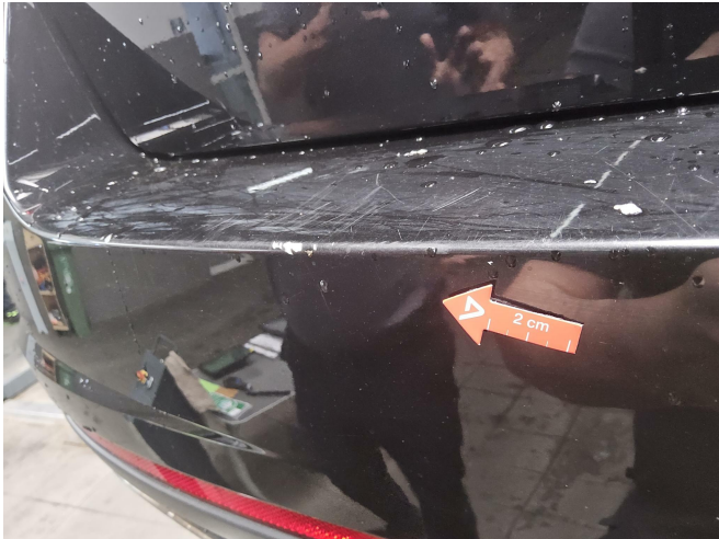
Bild 1: Außen, Stoßfänger hinten, Kratzer , lackieren
