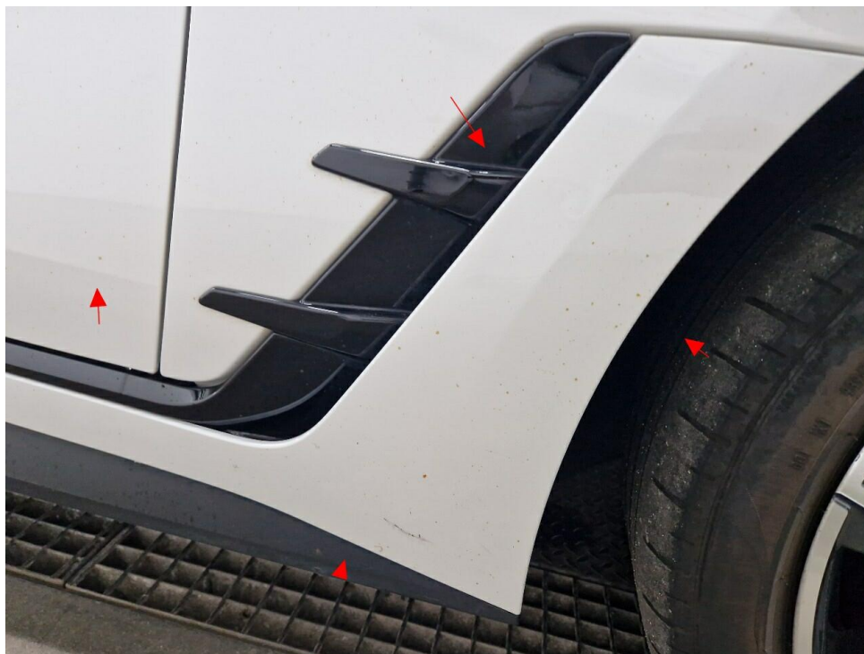
Bild 21 : Lackbereich mit Flugrost beaufschlagt
