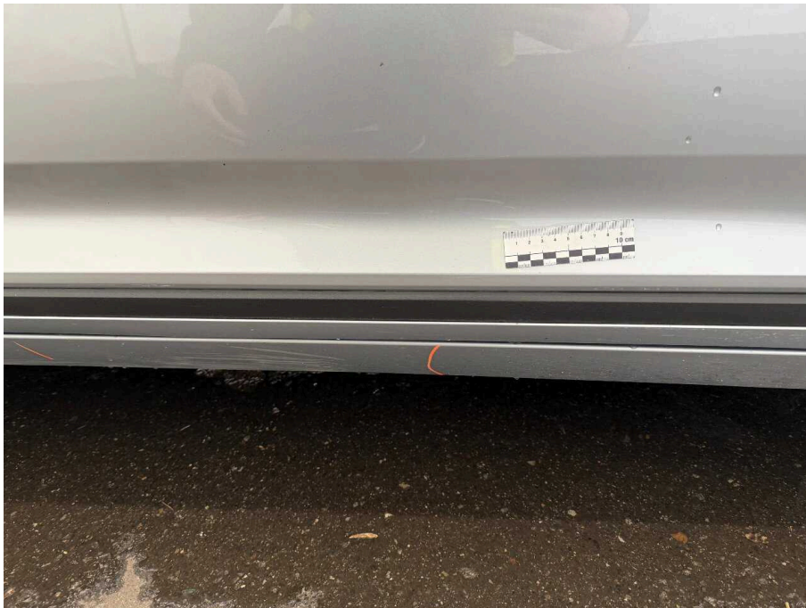
Bild 37 rechte Seite Schwellerverkleidung rechts verschürft
