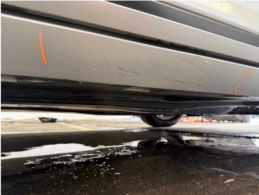
Bild 39 rechte Seite Schwellerverkleidung rechts verschürft
