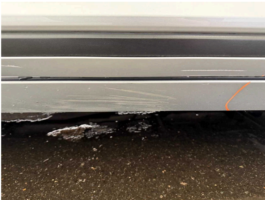
Bild 38 rechte Seite Schwellerverkleidung rechts verschürft
