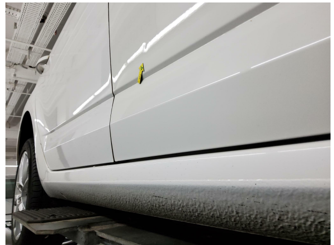
Bild 8: Außen, Tür vorne rechts, Delle, smart repair
