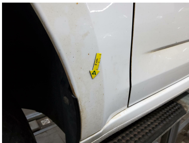
Bild 6: Außen, Fahrzeug - Lackierung, Oberflächenkratzer, Dellen, Steinschläge, Flugrost
