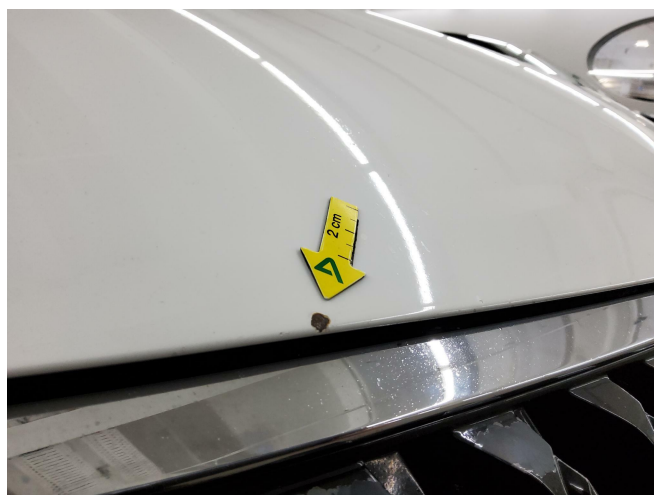
Bild 2: Außen, Motorhaube, Steinschlag/ Rostansatz, smart repair
