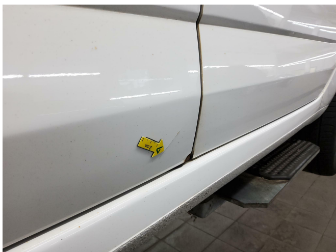
Bild 5: Außen, Tür vorne links, Beschädigung/ Rostansatz, instandsetzen und lackieren mit Lackaufbau
