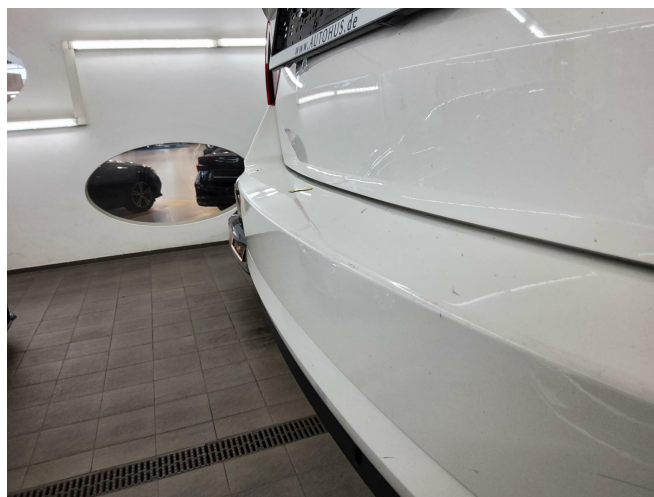
Bild 4: Außen, Stoßfänger hinten, Beschädigung/ Kratzer, smart repair
