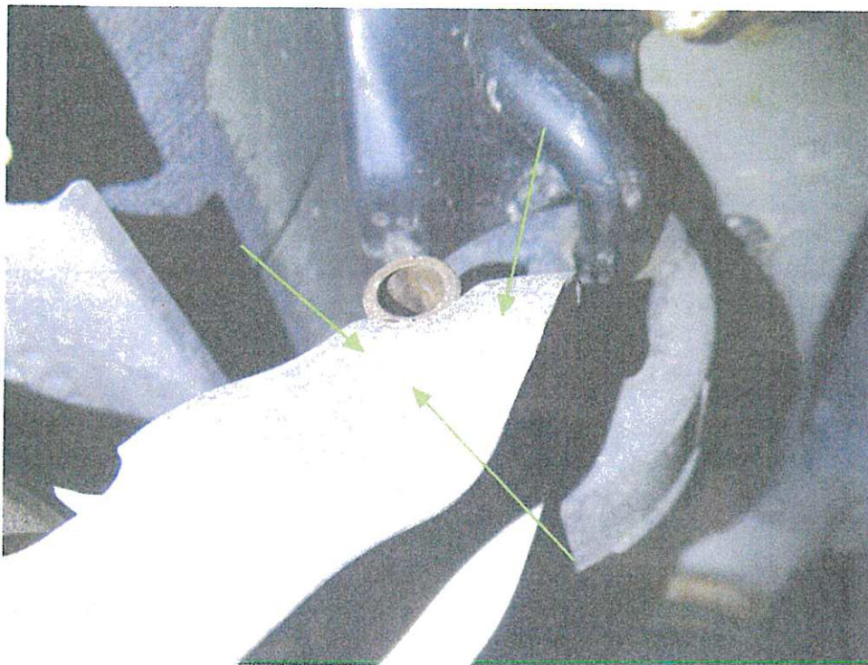
Bild 22 : Endtopf durch Anstoß verschrammt
