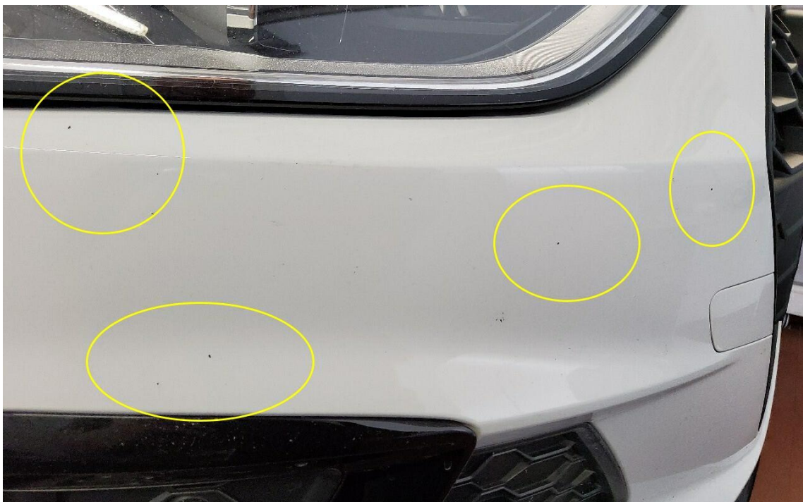
Bild 22 : Stoßfänger vorne Lackierung, Steinschlag, lackieren mit Lackaufbau
