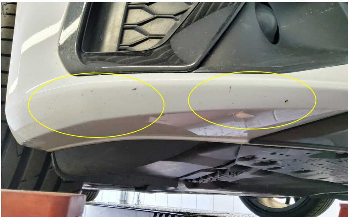
Bild 26 : Frontspoiler Lackierung, Steinschlag, lackieren mit Lackaufbau
