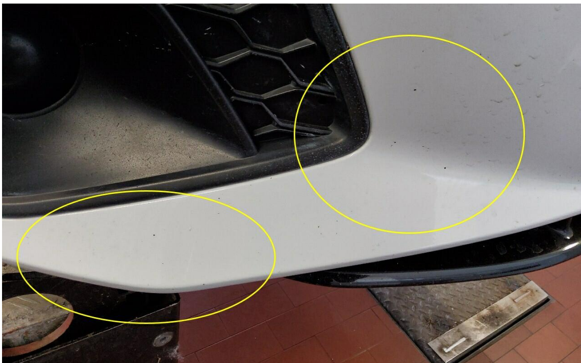
Bild 24 : Frontspoiler Lackierung, Steinschlag, lackieren mit Lackaufbau
