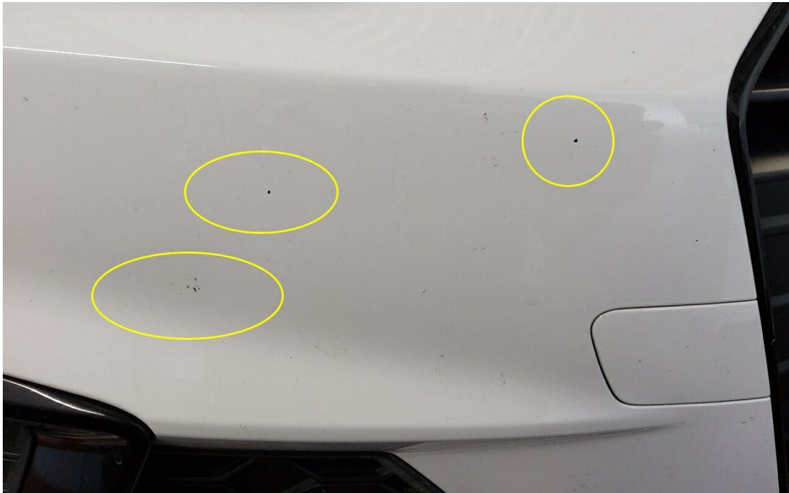
Bild 21 : Stoßfänger vorne Lackierung, Steinschlag, lackieren mit Lackaufbau
