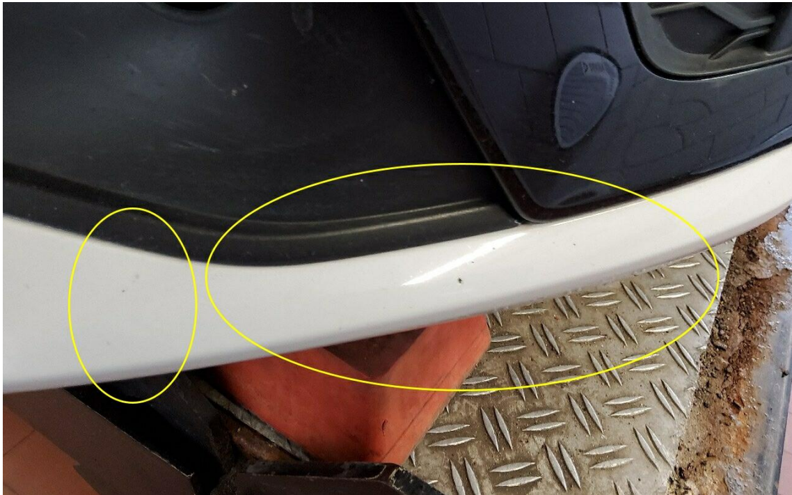
Bild 25 : Frontspoiler Lackierung, Steinschlag, lackieren mit Lackaufbau
