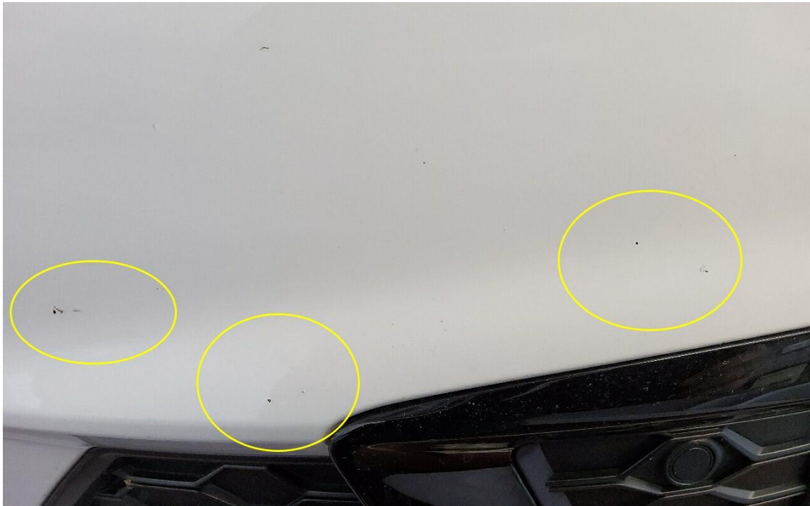
Bild 23 : Stoßfänger vorne Lackierung, Steinschlag, lackieren mit Lackaufbau
