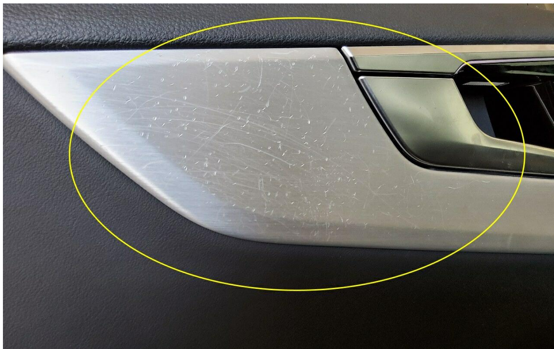
Bild 15 : Blende Seitenverkleidung vorne links eingekerbt,
