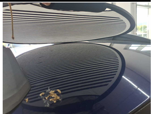
Damage #7: Roof: Roof (Vorbehaltlich Folgekosten) - dent(s) - Smooth repair work
