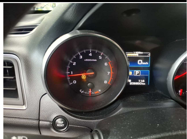
Damage #4: Instrument panel: Indicator light (Reifen, vorbehaltlich Folgekosten) - on - Diagnosed and repair if
