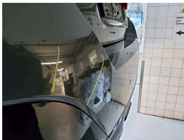
Bild 14: Stoßfänger hinten Mitte - Delle
