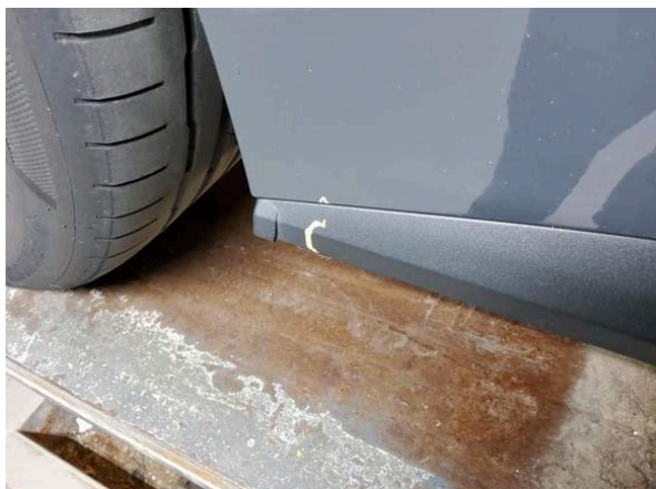
Bild 17: Schweller rechts - Delle, beschädigt
