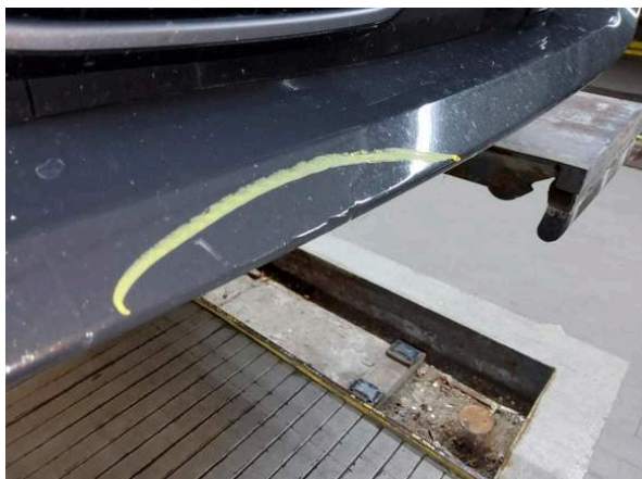
Bild 11: Stoßfänger vorne - Instands. und lackieren
