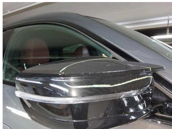
Bild 18: Außenspiegel rechts - Kratzer
