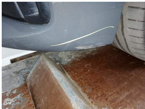
Bild 12: Stoßfänger vorne - Instands. und lackieren
