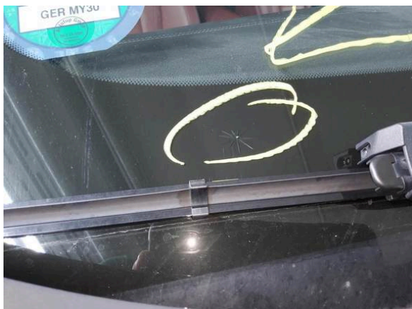
Bild 21: Windschutzscheibe - Riss, Austausch empfohlen, kleine Steinschläge
