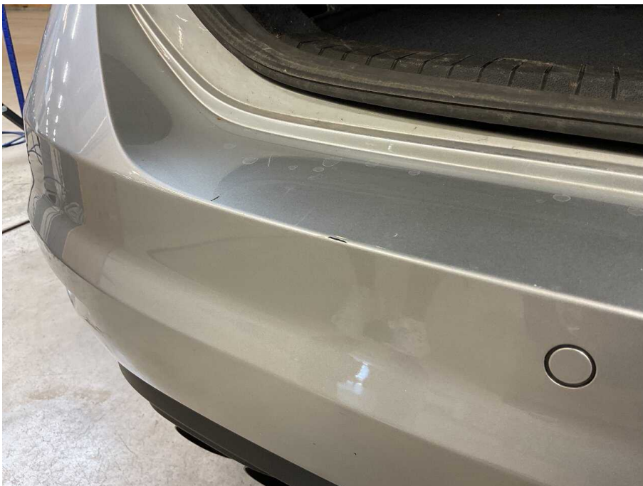
Bild 46 Fahrzeugheck Stoßfänger hinten Kratzer und Delle
