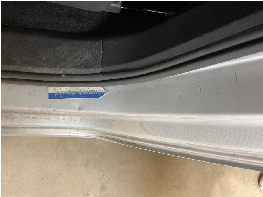
Bild 35 linke Seite Türeinstieg hinten links Kratzer und Dellen
