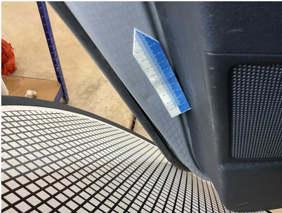
Bild 33 linke Seite Tür hinten links Dellen
