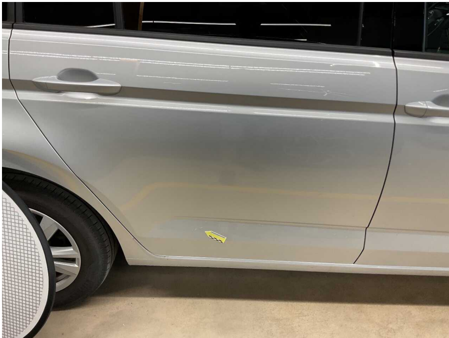
Bild 51 Fahrzeugheck Tür hinten rechts Kratzer und Delle
