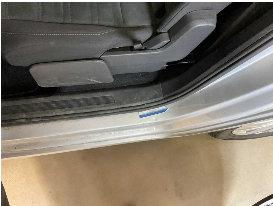
Bild 34 linke Seite Türeinstieg hinten links Kratzer und Dellen
