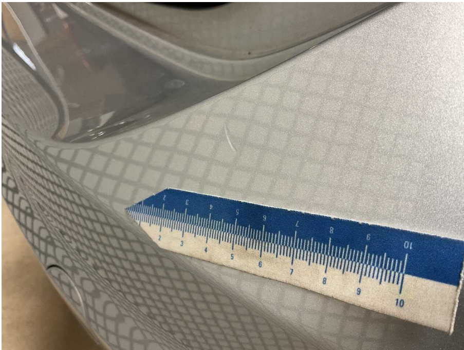
Bild 45 Fahrzeugheck Stoßfänger hinten Kratzer und Delle
