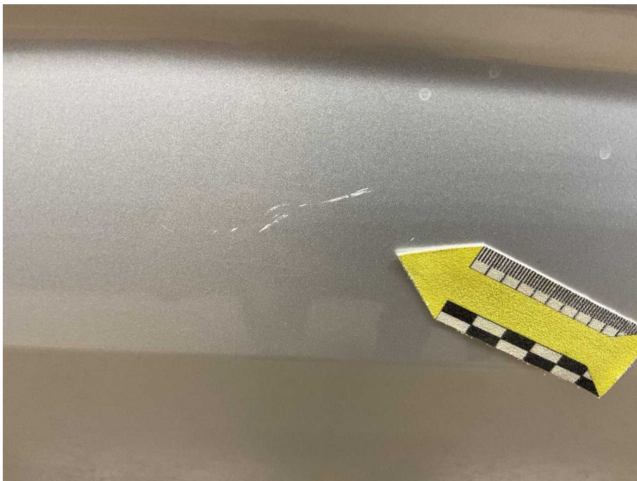
Bild 52 Fahrzeugheck Tür hinten rechts Kratzer und Delle
