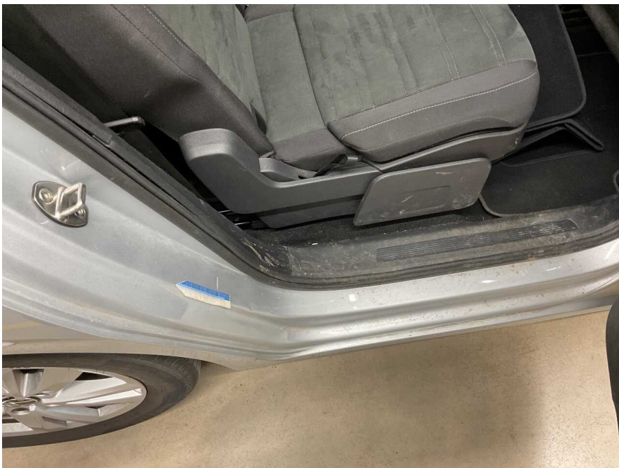
Bild 54 rechte Seite Türeinstieg hinten rechts Kratzer und Dellen
