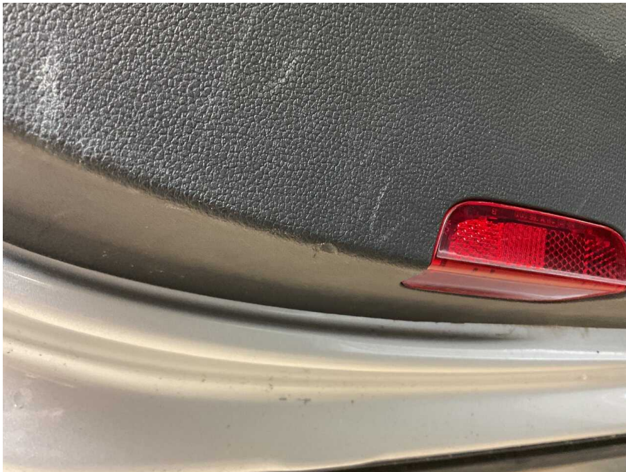
Bild 37 Innenraum Türverkleidung hinten links Gebrauchsspuren
