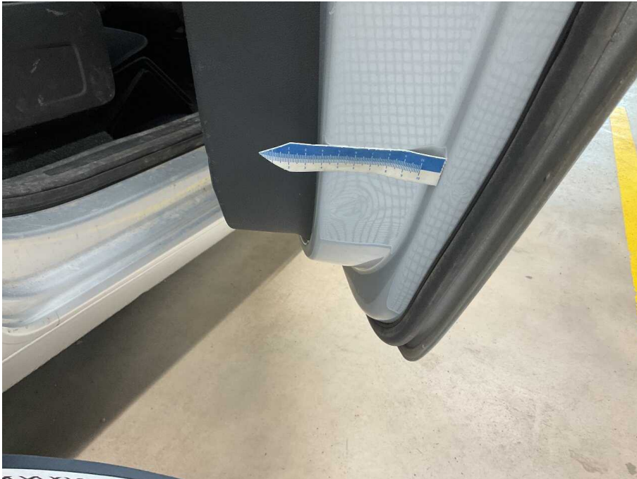
Bild 53 Fahrzeugheck Tür hinten rechts Kratzer und Delle
