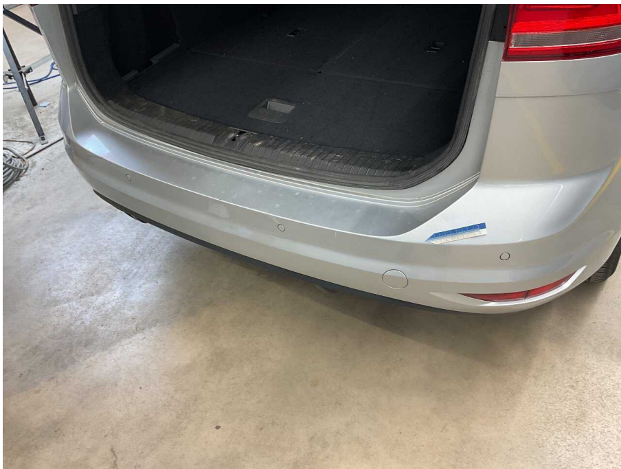
Bild 44 Fahrzeugheck Stoßfänger hinten Kratzer und Delle
