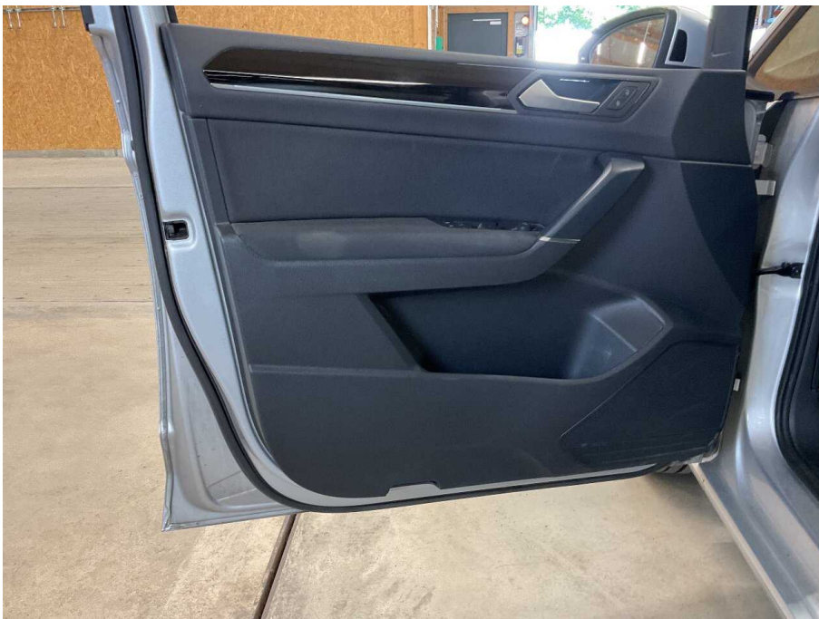
Bild 28 Innenraum Türverkleidung vorne links Blende fehlt
