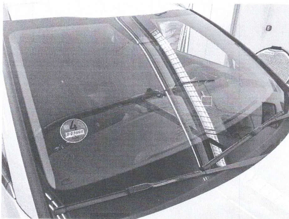
Bild 9 : Frontscheibe, Steinschlag mit Rissbildung
