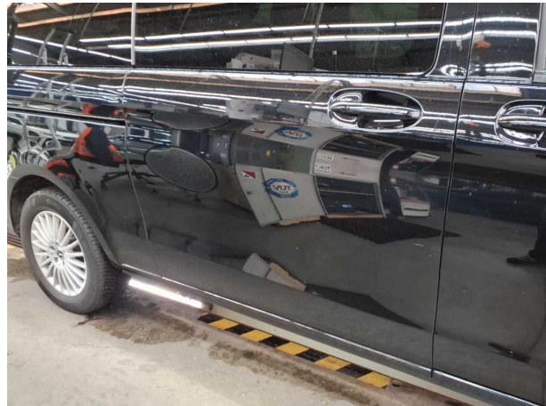
Schiebetür rechts: Schiebetür mit Glasscheibe - Kratzer - lackieren
