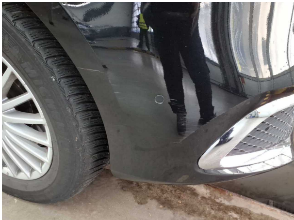
Stossfänger vorn: Stossfänger mit Parktronic - verkratzt / verschürft - lackieren
