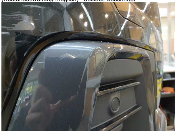
Beschädigung 2: Stossfänger vorn: Blende Stossfänger vorn (rechts) - Kratzer
