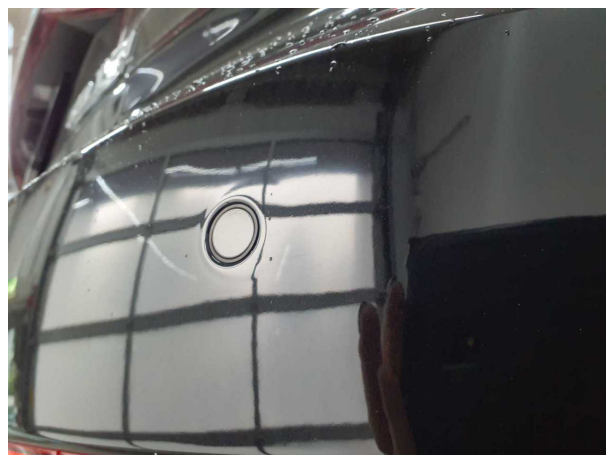
Beschädigung 3: Stossfänger hinten: Stossfänger hinten (PDC; Schleifspuren) - nicht fachgerecht instandgesetzt
