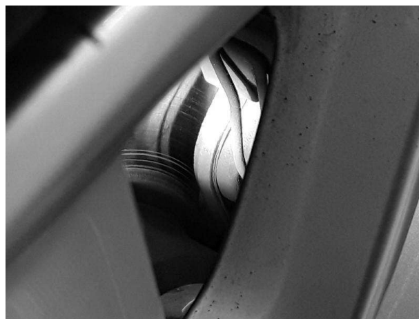
Bremsanlage, Bremsscheiben und Beläge vorn, verschlissen, kein Abzug - keine Angabe - keine Anga.. 1045600081_20250505_103757.jpg (TÜV SÜD)
