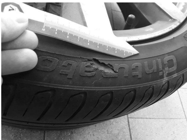
2.Radsatz, 1 Reifen, gebrochen / gerissen, erneuern - keine Angabe - keine Angabe 1045616346_20250505_104924.jpg (TÜV SÜD)
