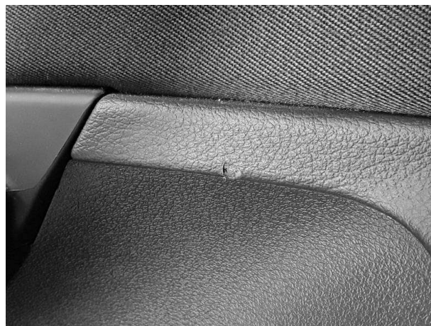
Verkleidungen / Abdeckungen, Türverkleidung vorn links, Kratzer, Smart Repair - keine Angabe - kein.. 1045676298_20250505_112804.jpg (TÜV SÜD)
