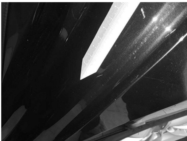
Seitenwand links, Einstieg, Kratzer, Smart Repair - keine Angabe - keine Angabe 1045636339_20250505_110052.jpg (TÜV SÜD)
