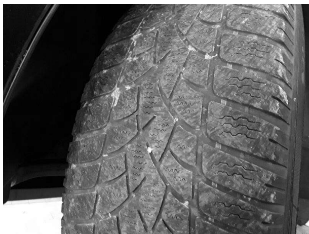
Rad/Reifen, Reifensatz komplett, verschlissen, erneuern - keine Angabe - keine Angabe 1045594158_20250505_103429.jpg (TÜV SÜD)
