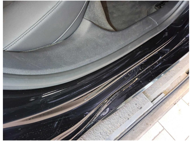
Tür hinten rechts Einstieg Lackierung, zerkratzt, smart repair (DEKRA)
