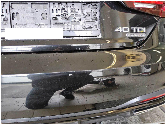
Stoßfänger hinten, zerkratzt, polieren (DEKRA)
