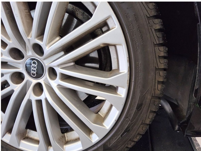
Leichtmetallfelge Winterräder vorn rechts verschrammt (DEKRA)
