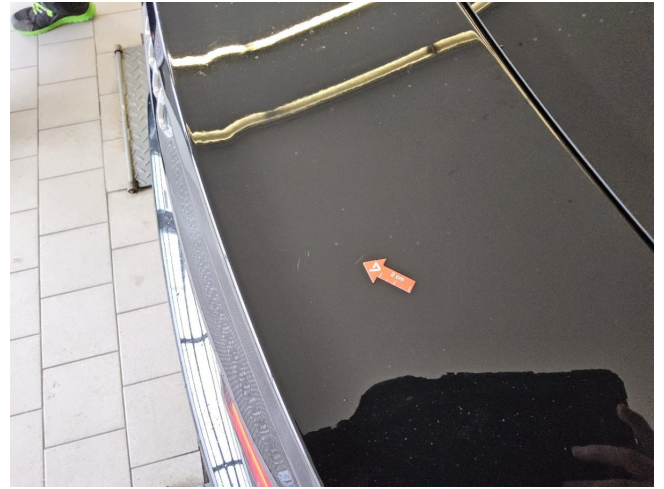
Tiefe Oberflächenkratzer rundum, erhöhter Polieraufwand (DEKRA)
