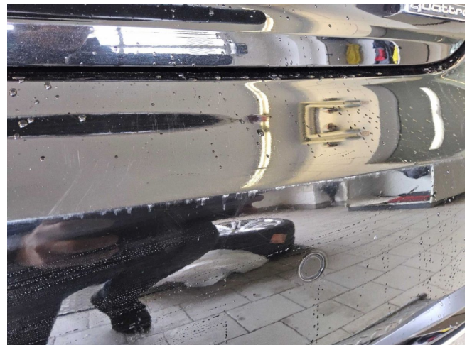
Stoßfänger hinten, zerkratzt, polieren (DEKRA)
