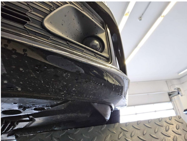
Frontspoiler, zerkratzt, Gebrauchsspur (DEKRA)
