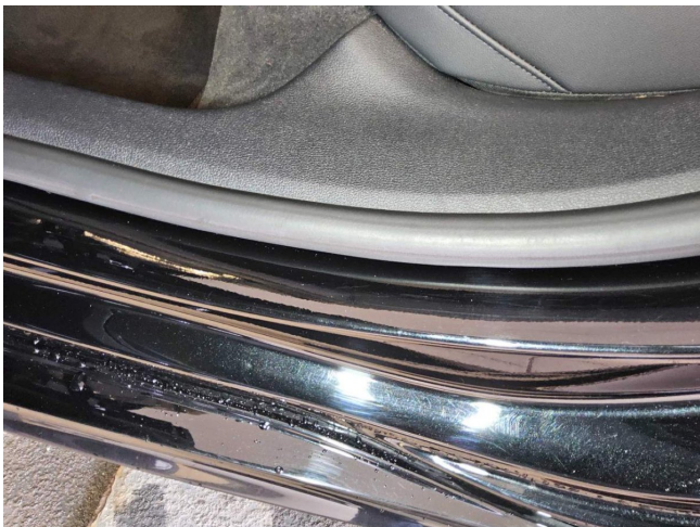
Tür hinten links Einstieg Lackierung, zerkratzt, Gebrauchsspur (DEKRA)
