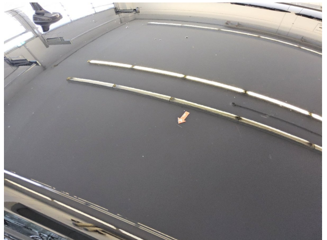
Tiefe Oberflächenkratzer rundum, erhöhter Polieraufwand (DEKRA)
