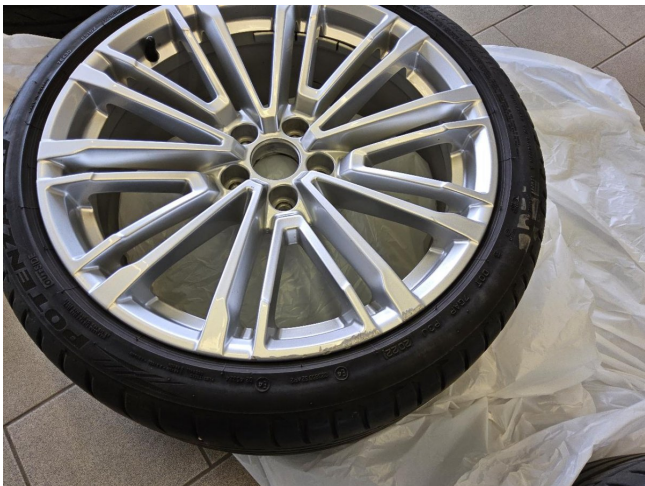
Leichtmetallfelge Sommerräder hinten rechts verschrammt (DEKRA)
