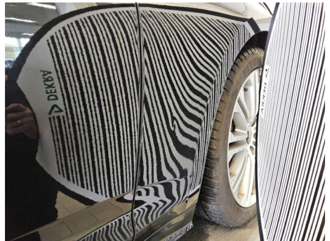
Kotflügel vorne rechts, eingedellt, drücken (DEKRA)
