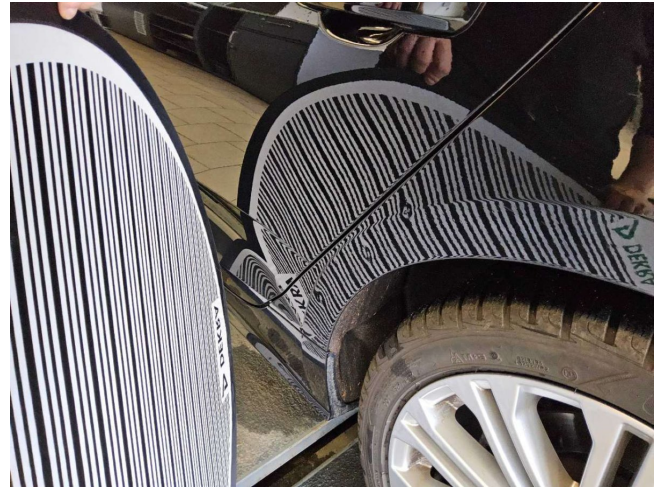
Seitenteil hinten links, mehrfach eingedellt, instandsetzen und lackieren mit Lackaufbau (DEKRA)
