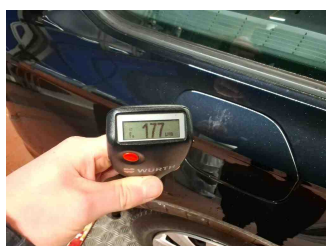
Lackstärke Seitenwand hinten rechts
