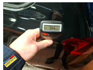
Lackstärke Seitenwand hinten links
