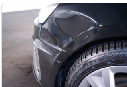
Kotflügel li : beschädigt
