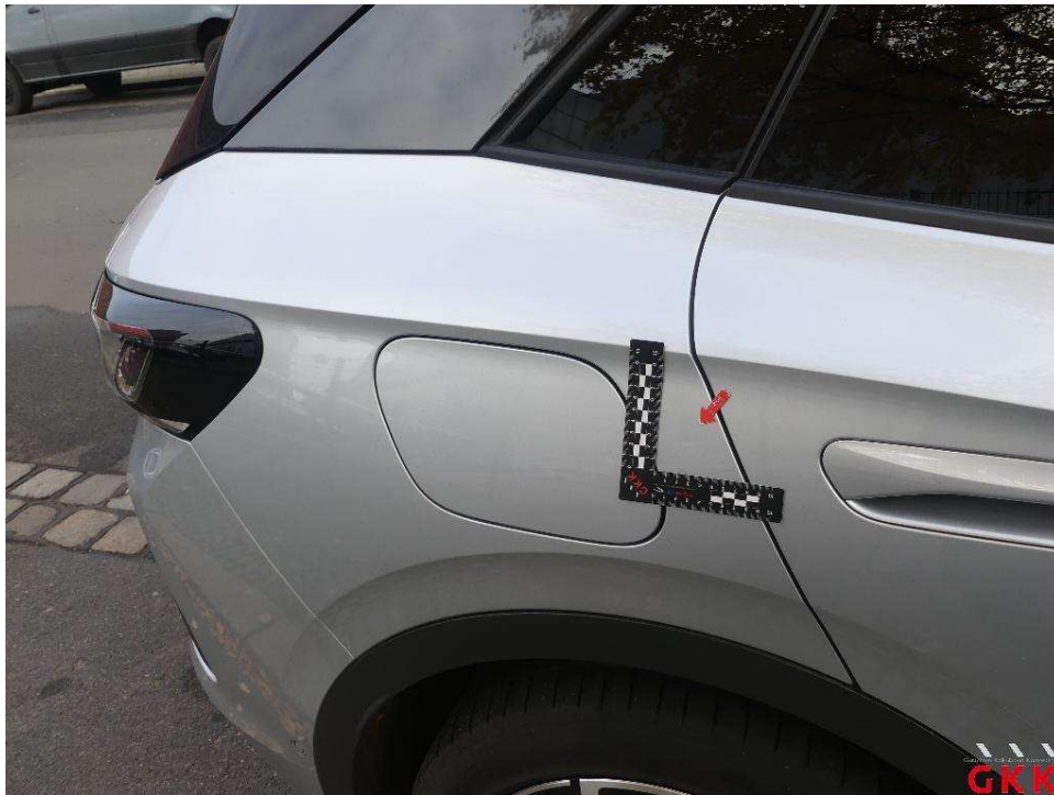
Bild 19. Seitenwand rechts, bis 3 Dellen / Bauteil, kalt drücken
