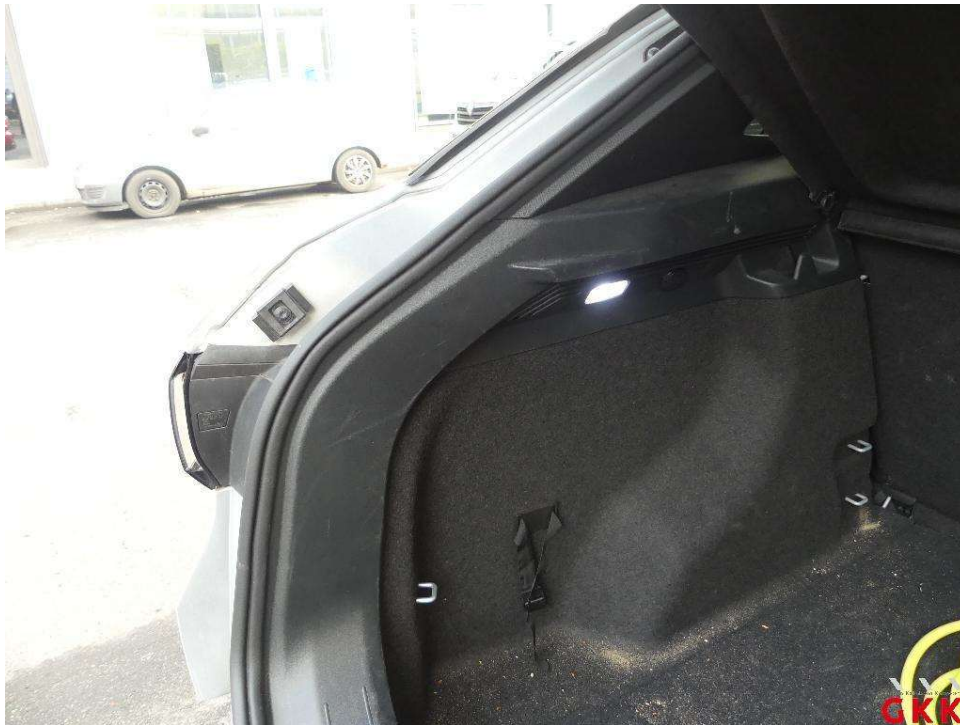
Bild 31. Seitenwand links, Innenverkleidung, verkratzt, ersetzen
