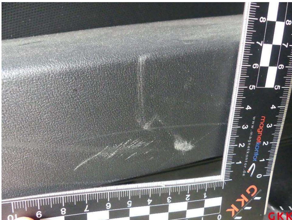
Bild 32. Seitenwand links, Innenverkleidung, verkratzt, ersetzen
