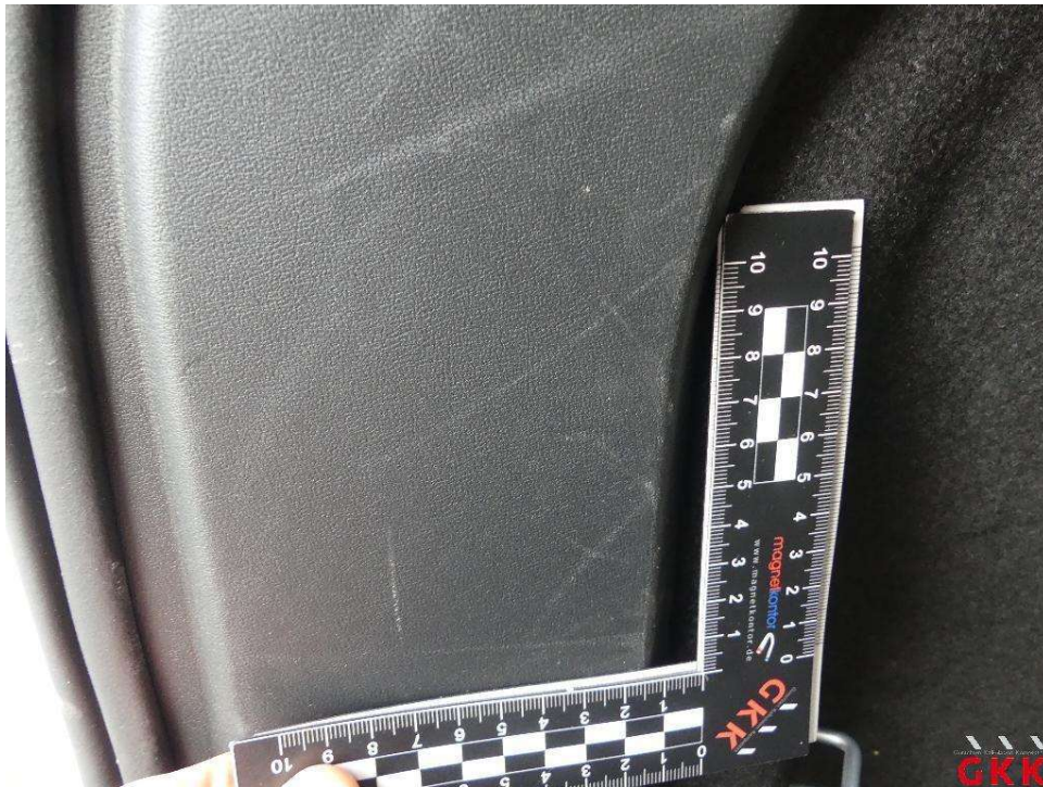
Bild 33. Seitenwand links, Innenverkleidung, verkratzt, ersetzen
