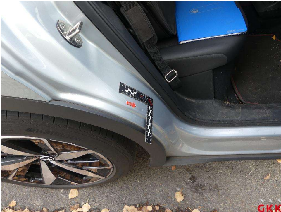
Bild 16. Tür hinten rechts, Einstieg, beschädigt, instand setzen - lackieren
