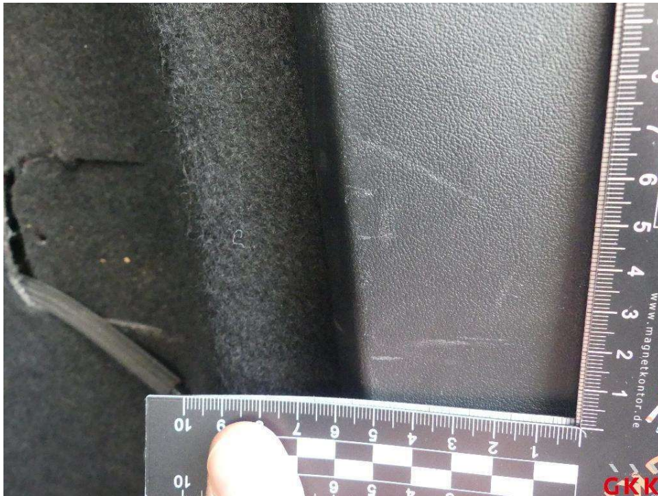
Bild 29. Seitenwand rechts, Innenverkleidung, verkratzt, ersetzen
