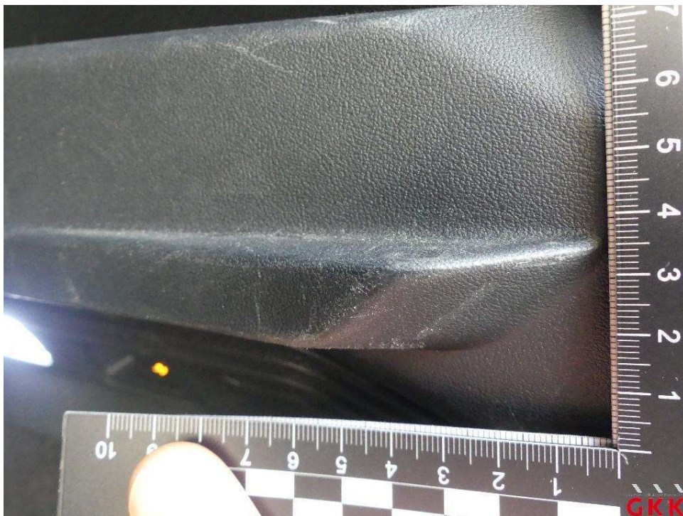
Bild 30. Seitenwand rechts, Innenverkleidung, verkratzt, ersetzen
