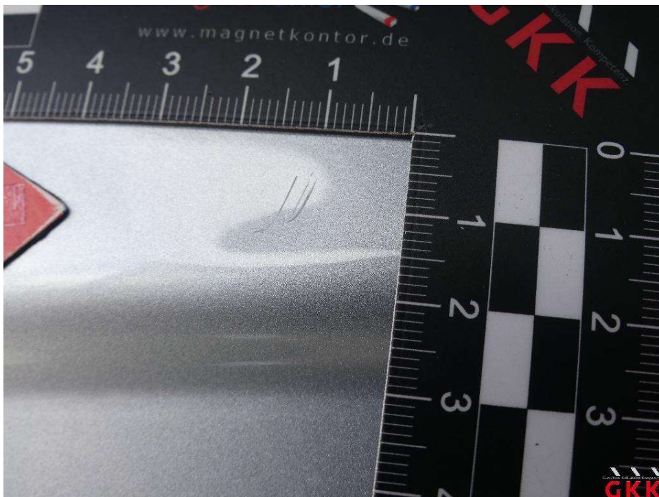
Bild 18. Tür hinten rechts, Einstieg, beschädigt, instand setzen - lackieren
