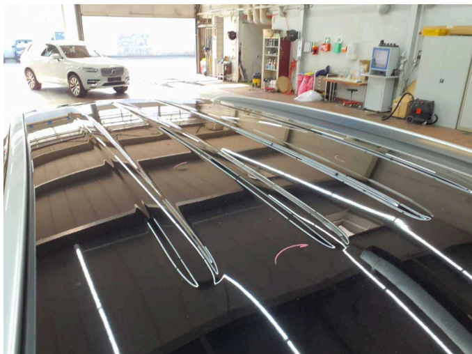
Beschädigung 7: Karosserie: Karosserie - Hagelschaden - instandsetzen lt. Kalkulation
