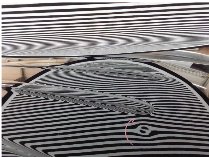
Beschädigung 7: Karosserie: Karosserie - Hagelschaden - instandsetzen lt. Kalkulation
