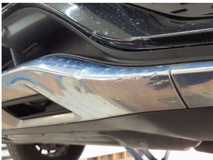
Beschädigung 2: Stossfänger vorn: Spoiler - verkratzt / verschürft - erneuern
