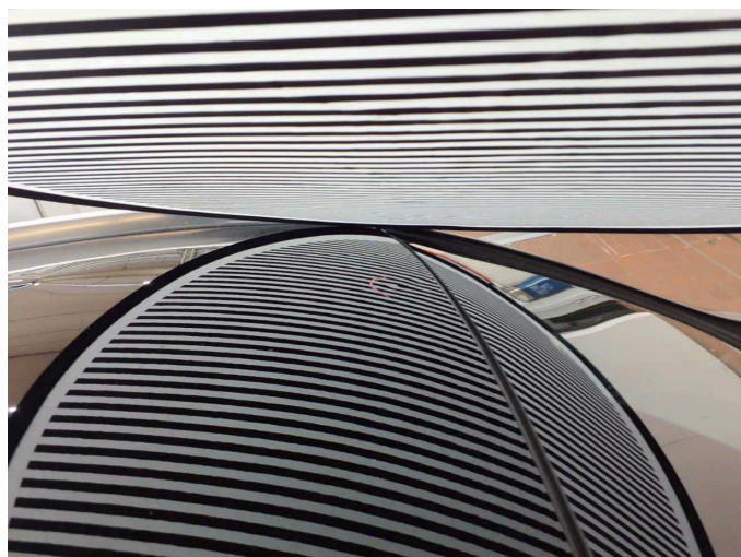
Beschädigung 7: Karosserie: Karosserie - Hagelschaden - instandsetzen lt. Kalkulation
