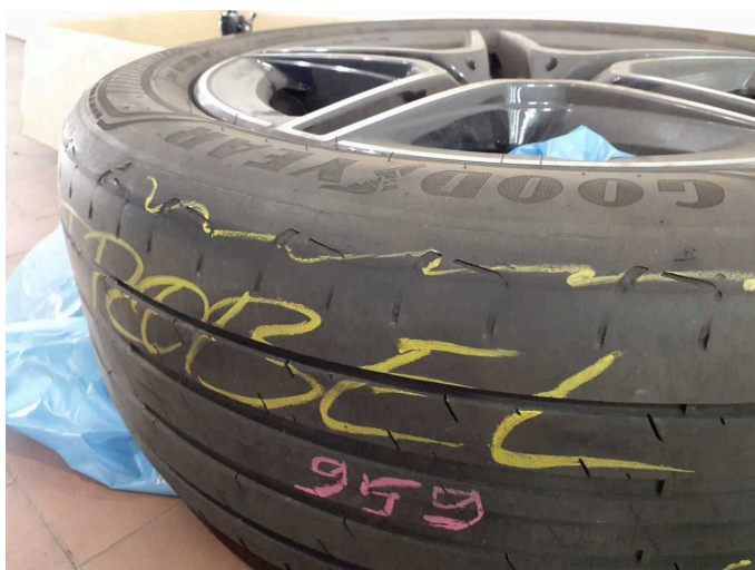
Beschädigung 5: 2.Radsatz: 1 Reifen - verschlissen - erneuern
