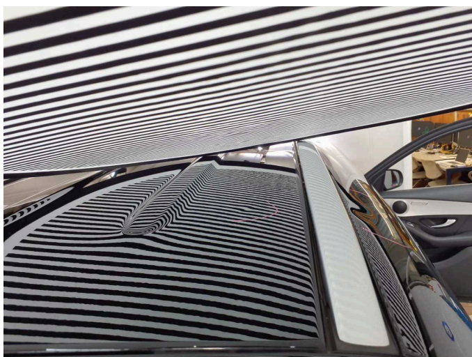
Beschädigung 7: Karosserie: Karosserie - Hagelschaden - instandsetzen lt. Kalkulation
