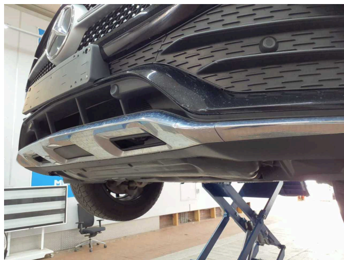
Beschädigung 2: Stossfänger vorn: Spoiler - verkratzt / verschürft - erneuern
