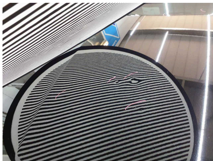
Beschädigung 7: Karosserie: Karosserie - Hagelschaden - instandsetzen lt. Kalkulation
