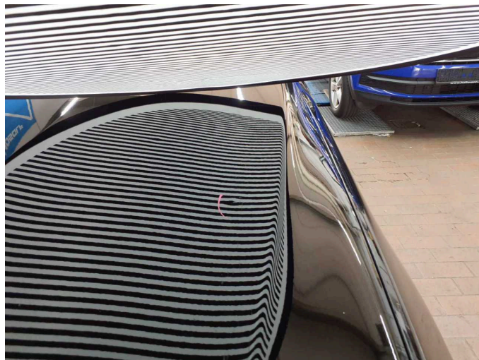
Beschädigung 7: Karosserie: Karosserie - Hagelschaden - instandsetzen lt. Kalkulation
