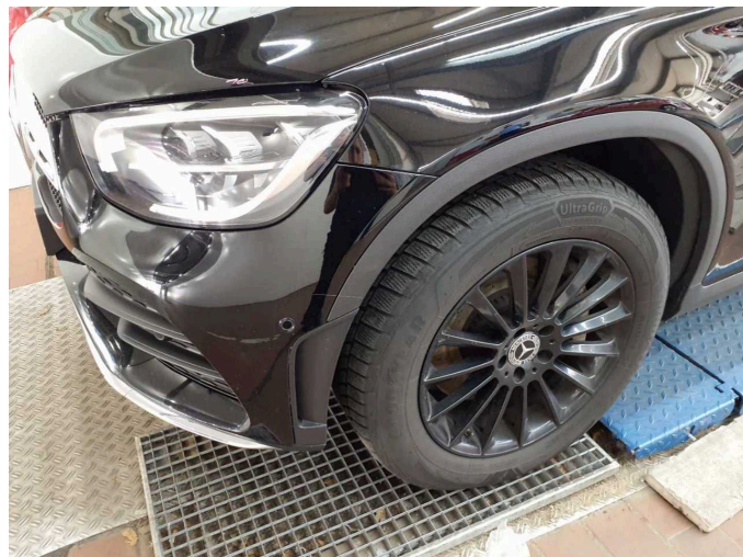
Beschädigung 1: Kotflügel links: Radhausverbreiterung - verkratzt / verschürft - Wertminderung
