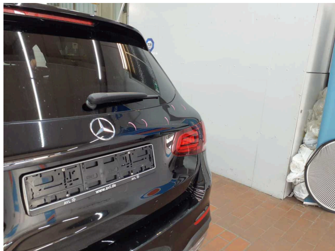
Beschädigung 7: Karosserie: Karosserie - Hagelschaden - instandsetzen lt. Kalkulation
