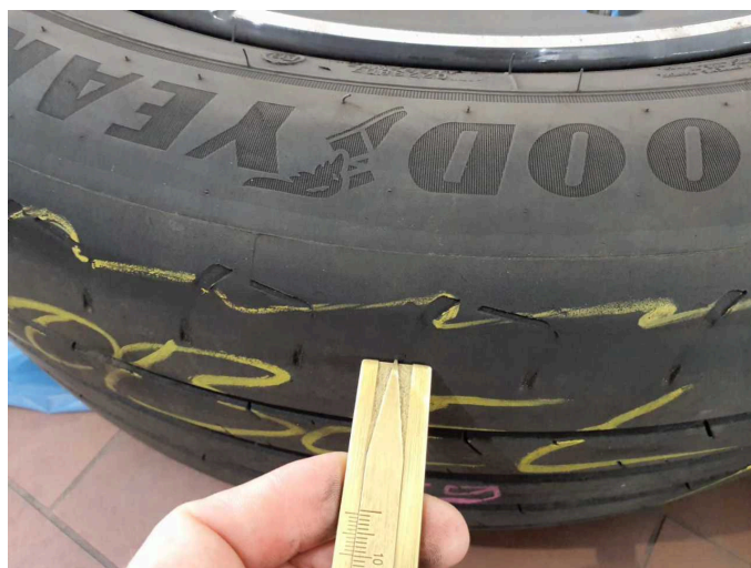
Beschädigung 5: 2.Radsatz: 1 Reifen - verschlissen - erneuern
