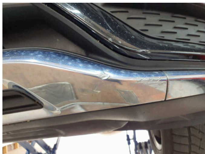
Beschädigung 2: Stossfänger vorn: Spoiler - verkratzt / verschürft - erneuern
