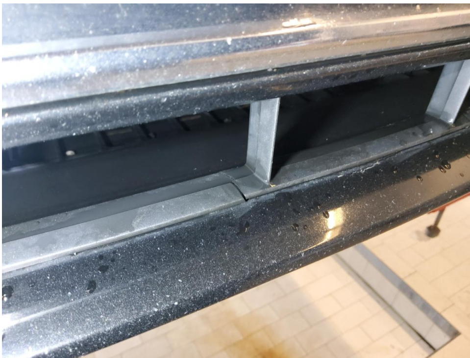
Lüftungsgitter Stoßfänger vorne gebrochen, ern.
