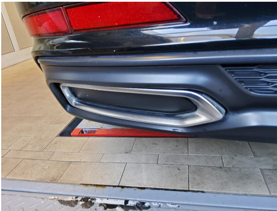
Blende Stoßfänger hinten deformiert, erneuern
