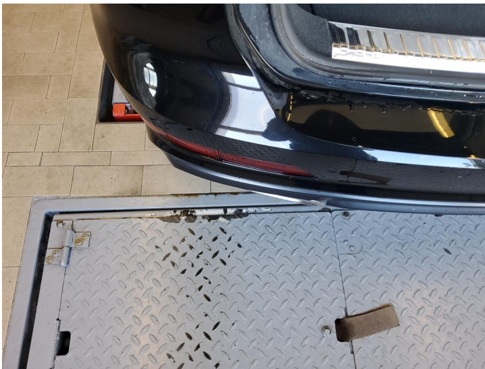
Blende Stoßfänger hinten deformiert, erneuern
