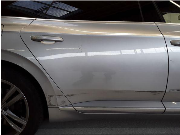
Seite rechts - beschädigt - instandsetzen
