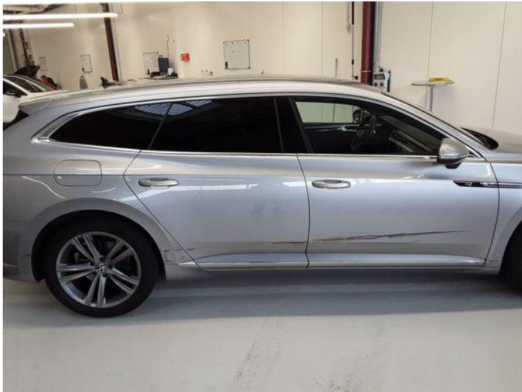
Seite rechts - Übersicht - beschädigt - instandsetzen
