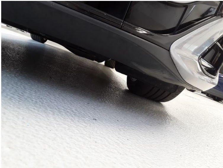
Spoiler vorn - beschädigt - ersetzen
