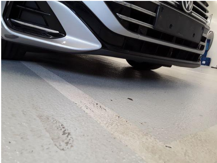
Spoiler vorn - Übersicht - beschädigt - ersetzen
