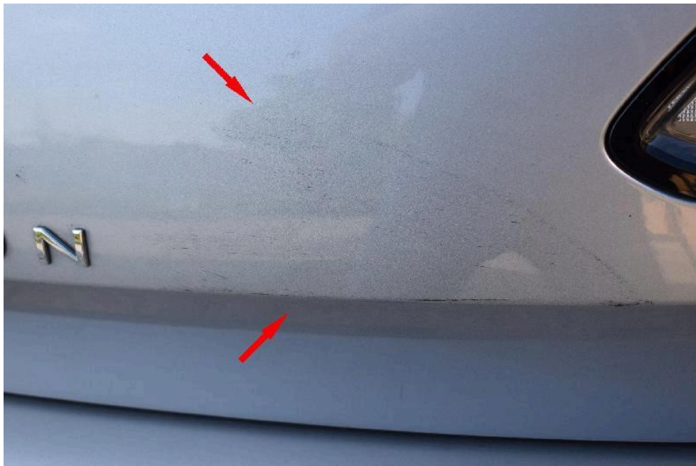
Bild: 4 Zwecks Darstellung wurde die Schadenstelle mit Kontrastmittel hervorgehoben. Heckklappe angestoßen und verschrammt.
