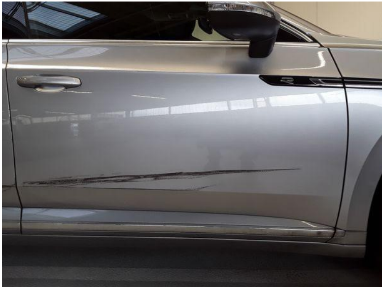
Seite rechts - beschädigt - instandsetzen
