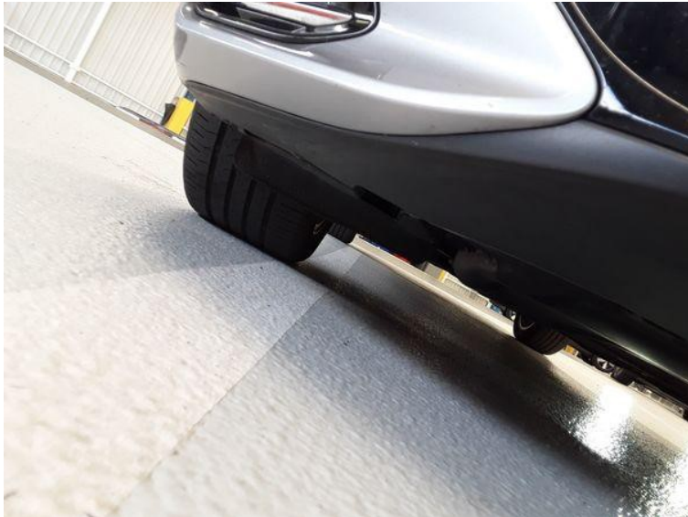
Spoiler vorn - beschädigt - ersetzen
