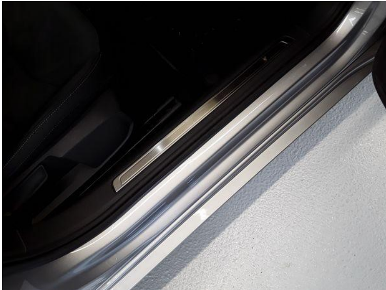
Schweller (Tür vorn) (rechts) - Übersicht - Dellen / Beulen - lackschadensfreie Instandsetzung
