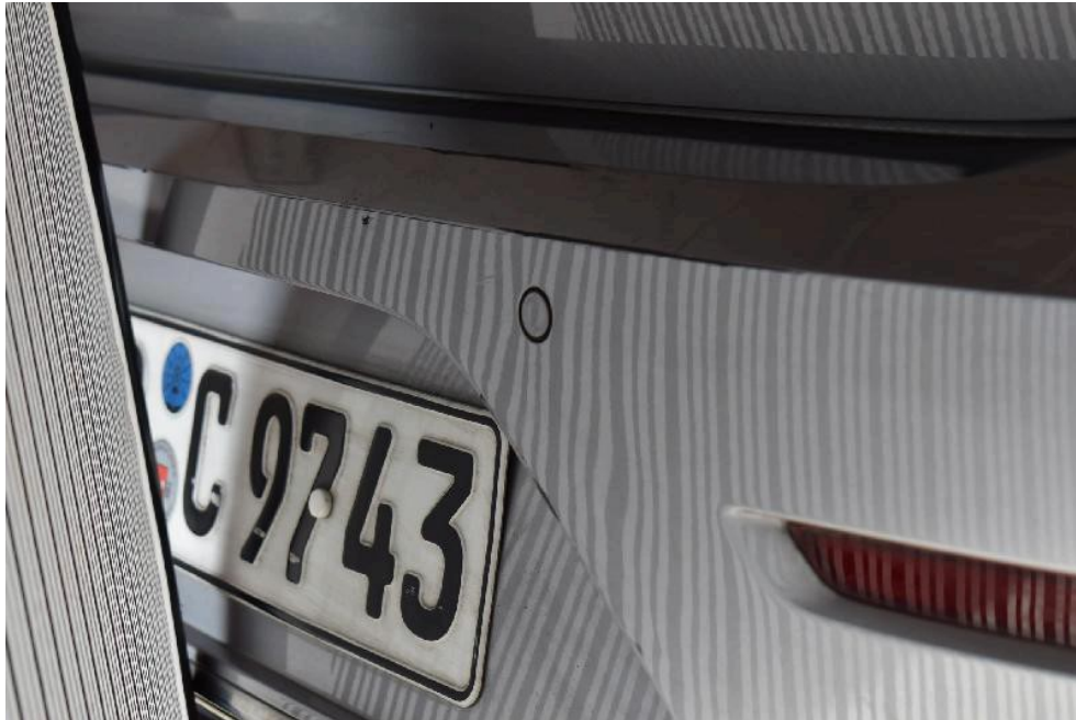
Bild: 7 Stoßfängerschale hinten mittig verschrammt und verformt. Kennzeichen verschrammt.
