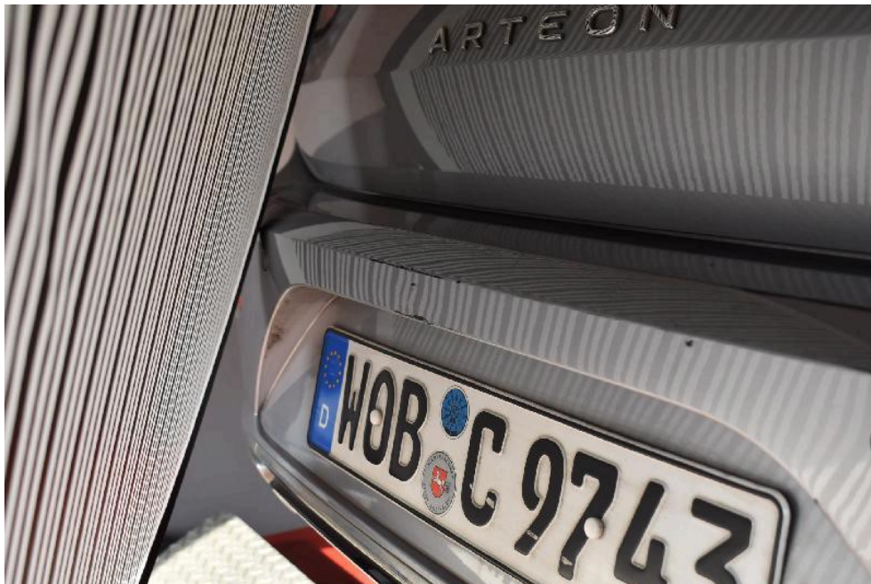
Bild: 6 Stoßfängerschale hinten mittig verschrammt und verformt. Kennzeichen verschrammt.
