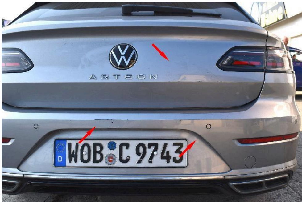
Bild: 2 Anstoß gegen das Fahrzeugheck. Stoßfängerschale hinten mittig verschrammt und verformt. Kennzeichen verschrammt. Heckklappe angestoßen und verschrammt.
