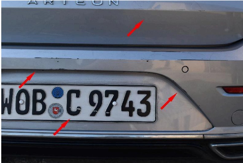
Bild: 3 Zwecks Darstellung wurde die Schadenstelle mit Kontrastmittel hervorgehoben.
