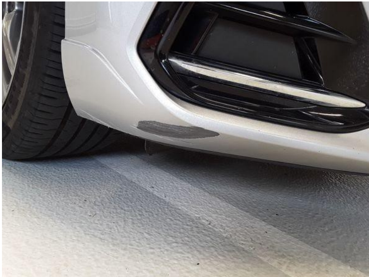
Stoßfänger vorn rechts - Lackschaden - lackieren
