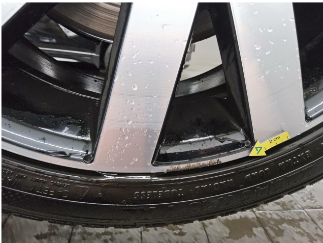
Bild 3: Außen, 1 Leichtmetallfelge, beschädigt , instandsetzen
