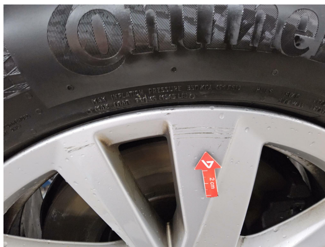
Bild 4: Außen, 1 Leichtmetallfelge , beschädigt , instandsetzen
