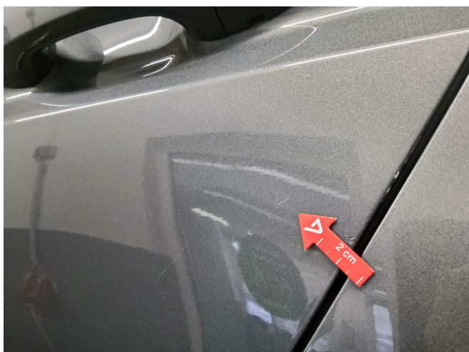
Bild 5: Außen, Tür hinten links, Kratzer , lackieren
