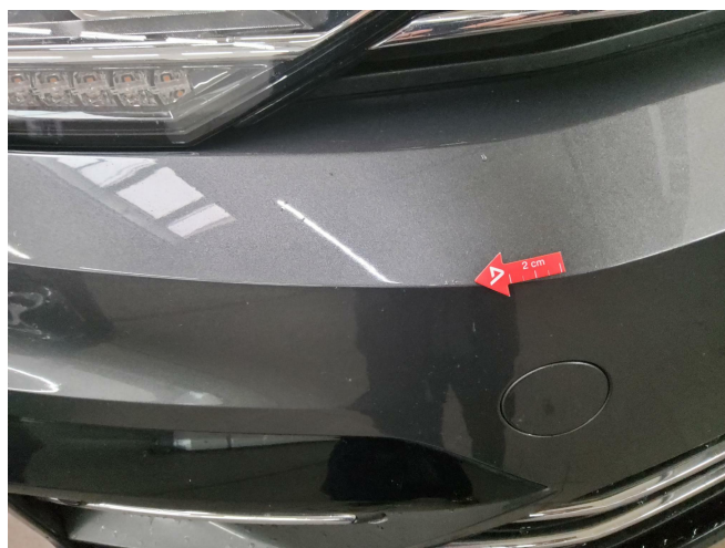
Bild 6: Außen, Stoßfänger vorne, Steinschläge , lackieren
