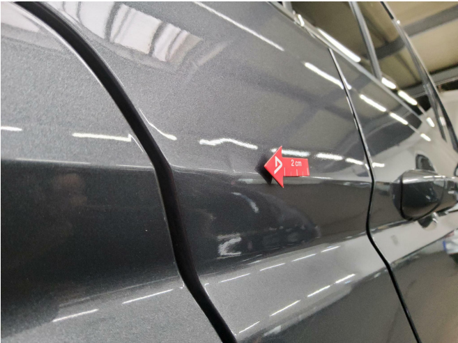
Bild 7: Außen, Seitenteil hinten rechts, Delle , smart repair
