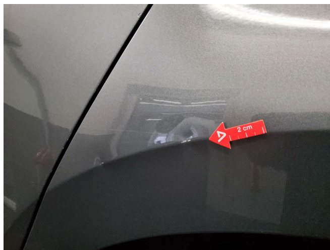
Bild 4: Außen, Seitenteil hinten links, Dellen, Kratzer , smart repair
